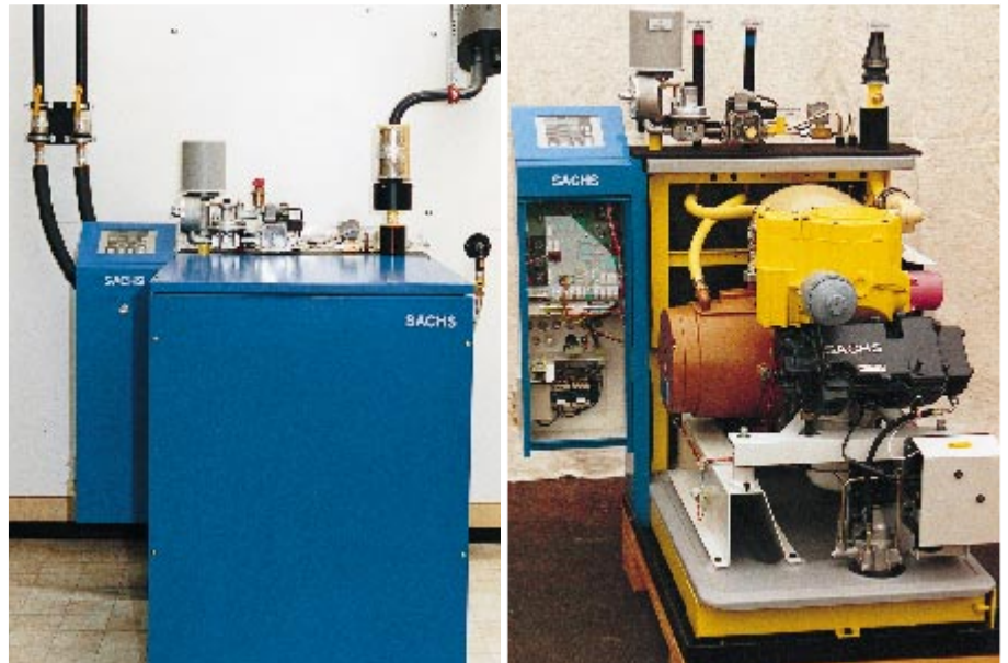
Abb. 1: Die kleine, kompakte und anschlussfertig lieferbare Heiz-Kraft-Anlage erzeugt Wärme und Strom gleichzeitig. Aggregat mit und ohne Gehäuse (Foto: Fichtel & Sachs GmbH, Schweinfurt)
