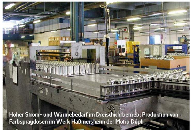
Hoher Strom- und Wärmebedarf im Dreischichtbetrieb: Produktion von Farbspraydosen im Werk Haßmersheim der Motip Dupli
