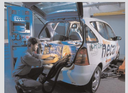
Abb. 6: PKW mit Methanol-PEMFC-Antrieb. Im Fahrzeug eingebaut sind der Methanol-Tank, ein Verdampfer und Reformer, eine Gasreinigungsstufe, die Brennstoffzellenstacks und ein Wassertank. (Daimler Benz AG)
