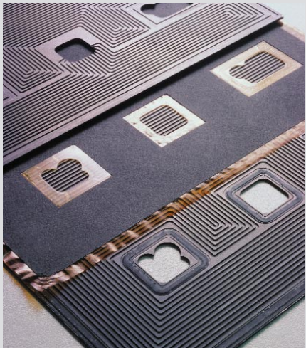
Abb. 3: Die Polymer-Membran zwischen den beiden Bipolarplatten (mit eingefrästen Transportkanälen) ist beidseitig mit einer dünnen Katalysatorschicht aus Platin sowie einer gasdurchlässigen Elektrode aus Graphitpapier beschichtet. (Daimler Benz AG)
