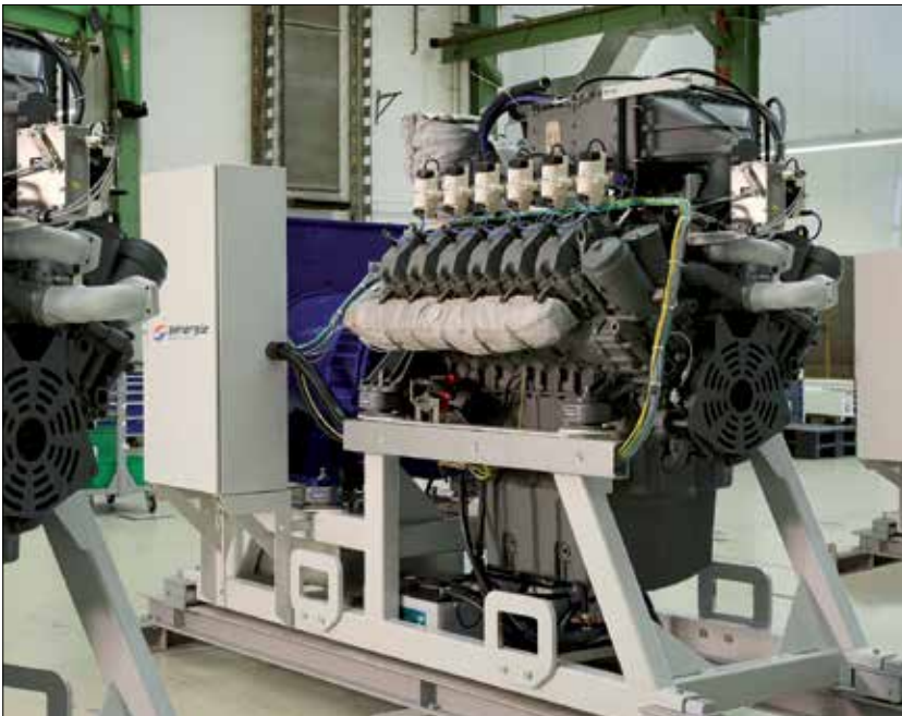
Bild 2. Der Bereich von Kompaktmodulen reicht inzwischen bis 500 kW; neue Konzepte sehen mehrmodulige Anlagen statt einmodulige Megawattblocks vor, um flexibler auf Strommarktpulse reagieren zu können Quelle: Senergie
