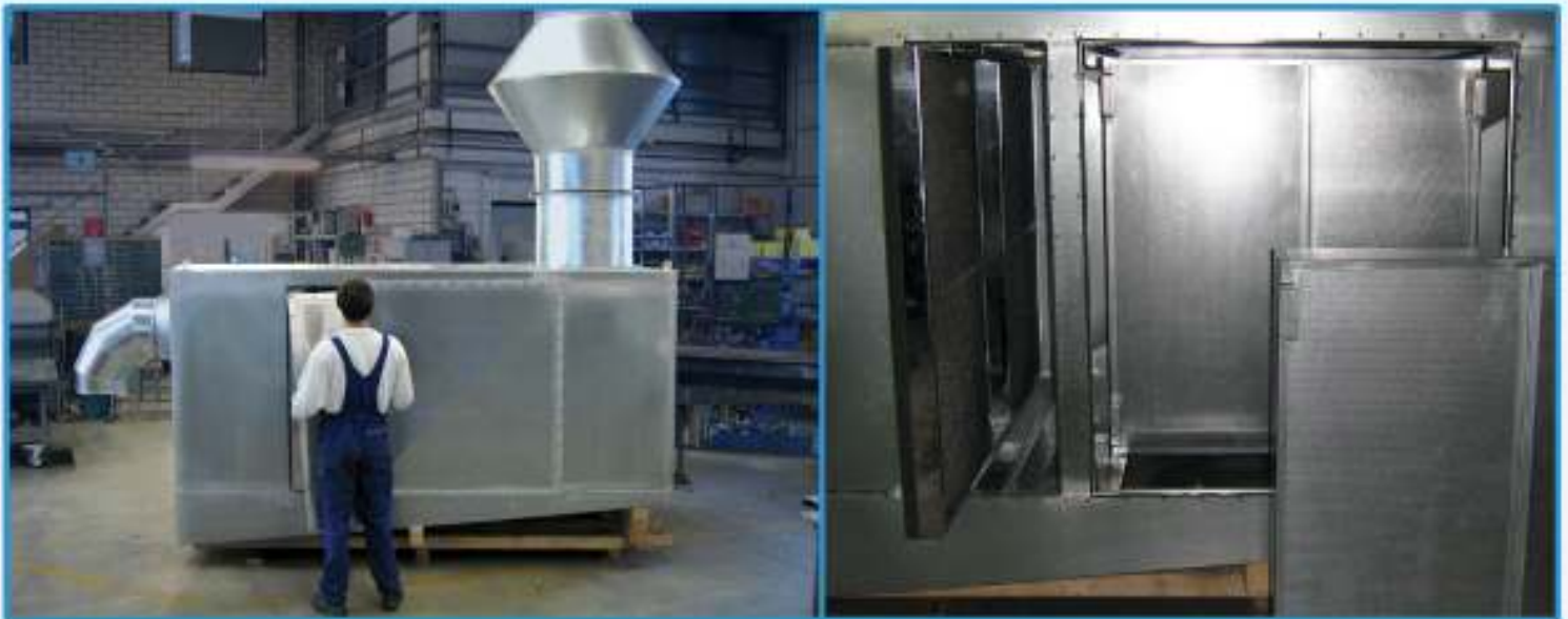
Kulissenschalldämpfer in dicht geschweisster Industriearbeit für ölhaltige Abluft mit integriertem Ölnelabscheider sowie Ölauffangwanne, Ablaufstutzen und angebauter Deflektorhaube
