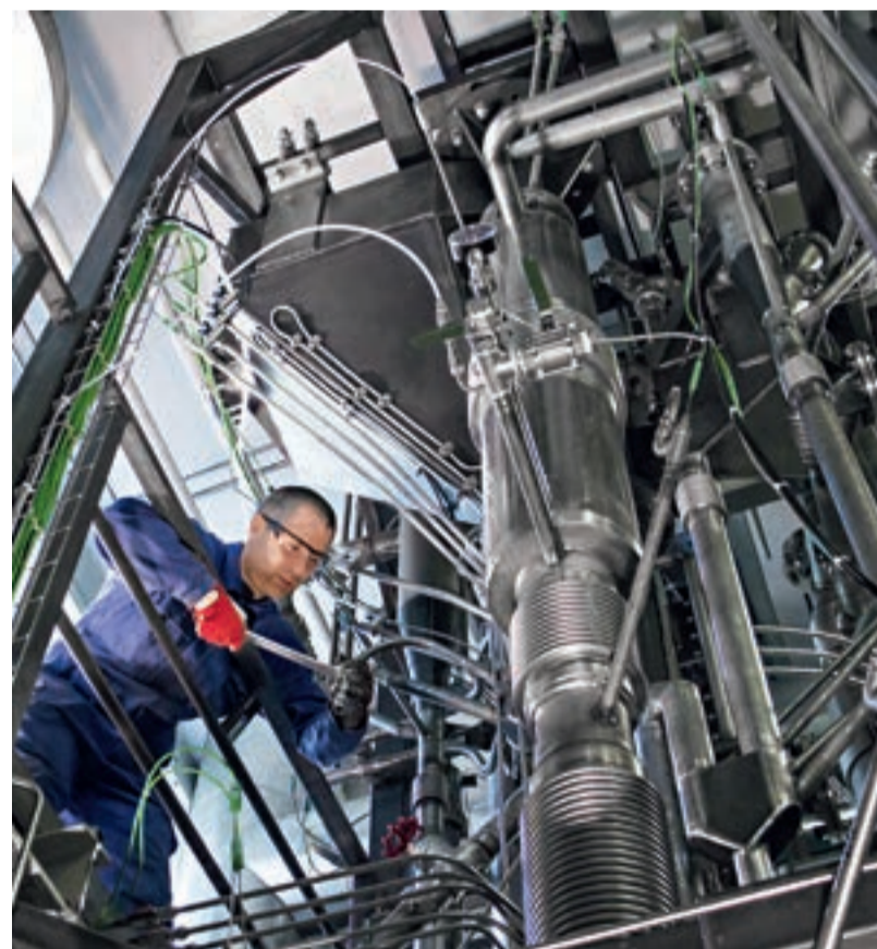
Johannes Schmid in der Versuchsanlage: „Durch eine neuartige Reaktorkonstruktion kommen der Brennstoff und dessen Produktgas viel intensiver in Kontakt mit dem wirbelnden heißen Sand“
